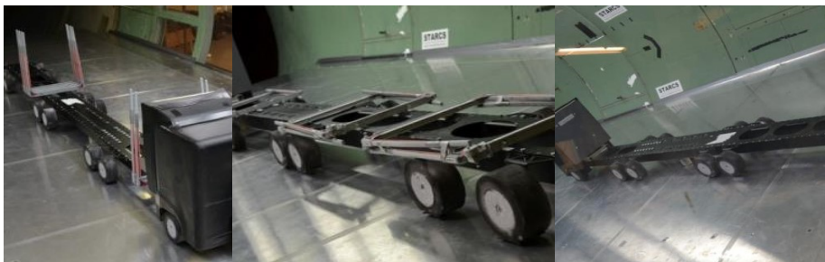
Figur 9. Från vänster med hopskjutna stakar, fällda stakar och inga stakar.
