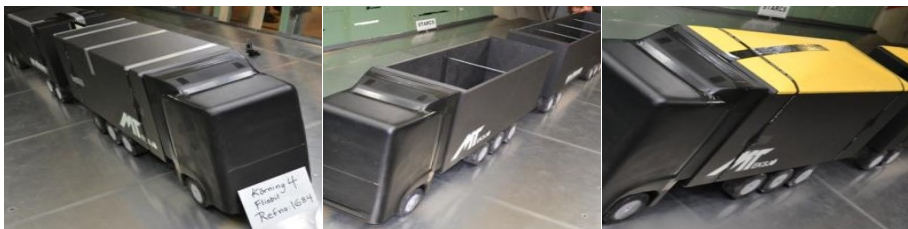
Figur 11. Från vänster; täckt, öppen och lastad konfiguration.
