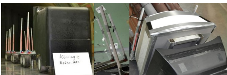
Figur 12. Från vänster; tom 60 tons konfiguration, Droppformade stakar, Boat Tail på framstammen som går över virket.
