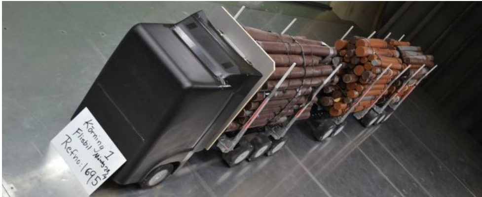
Figur 4. Referenskonfigurationen 74 tons rundvirkesbil. Högre travar och 9 hjulaxlar på fordonskombinationen.
