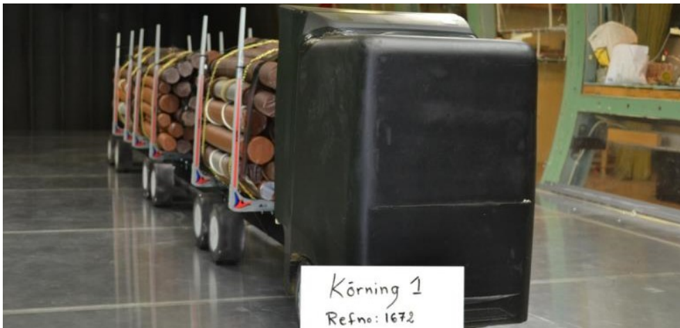
Figur 5. Referenskonfigurationen 60 tons rundvirkesbil. Lägre travar och 7 hjulaxlar på fordonskombinationen.
